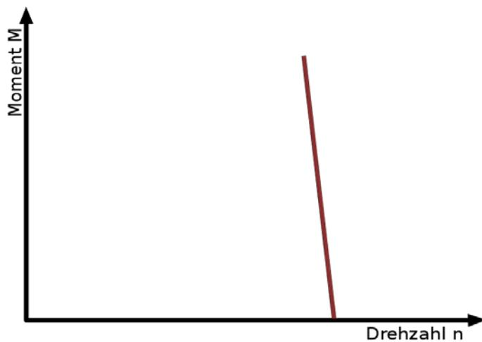
Abb. 13 Drehmoment-Drehzahl-Kennlinie einer Nebenschlussmaschine
